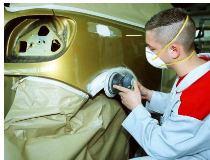
Die gespachtelte Fläche durch Schleifen glätten
